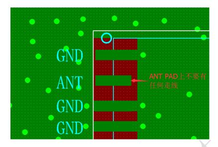
如果要兼容两种天线连接方式的话,可以在走线上串一颗 0 欧姆电阻,当使用模块上的 IPEX 射频座连接天线时,把这颗电阻空贴,断开 PCB 上面的走线。请注意这颗电阻必须尽可能的靠近模块放置!
