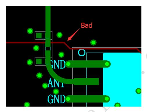
不良示例四: 阻抗线边上没有打足够的地孔;
