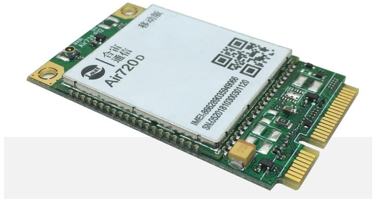
Air720DI 是合宙通信推出的一款中国移动定制版 LTE Cat.4 MiNiPCle 模块，采用 LTE 3GPP Rel.9 技术，支持最大下行速率150Mbps 和最大上行速率 50Mbps。
